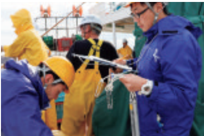
投縄作業において、釣針の設置水深を計測するため小型水温水深計を乗組員に手渡し、取付枝縄を記録している（マグロ延縄実習）
