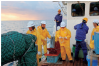
揚縄作業において、各枝縄の釣獲魚の有無を記録し、枝縄の収納と取り付けた小型水温水深計を回収している（マグロ延縄実習）
