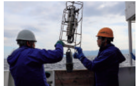
海中にCTD計測機を投入・揚収して観測点の電気伝導度、水温、水深を鉛直連続的に計測している（各計測および漁労実習）
